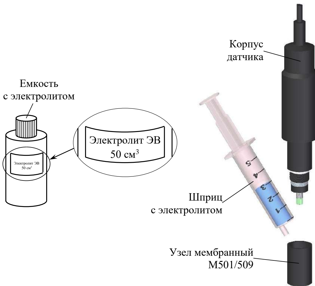
Рисунок 2.2 – Заливка (добавление) электролита
